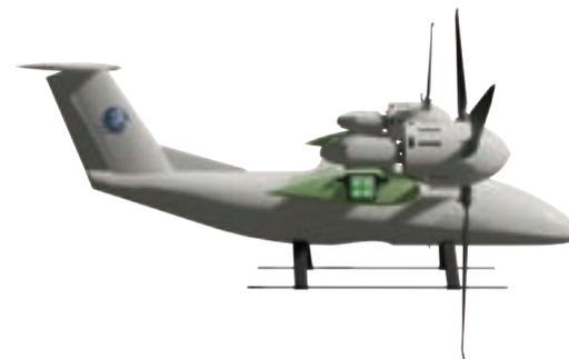
傾轉旋翼機可分為三種飛行型態：旋翼模式、轉換階段以及定翼模式。
